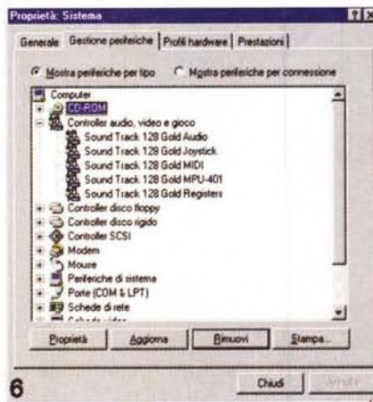
Figura 6 - Le proprietà di sistema, con i driver appena installati; sono 5 le componenti.
